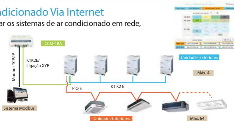
2) Método de ligação ao protocolo de comunicação (RTU)
